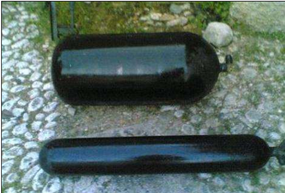
Serbatoi di metano compresso
